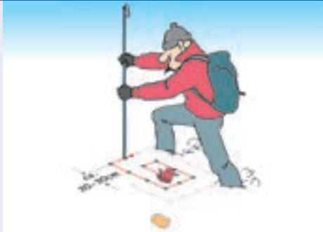
Abb. 1: Systematisch sondieren: vom LVS-Maximumpunkt mit 20 – 30 cm Abständen spiralförmig nach außen arbeiten.
